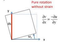
$$\begin{bmatrix} \frac{du}{ds} \\ \frac{dv}{ds} \end{bmatrix} \approx \begin{bmatrix} 0 & -\omega_z \\ \omega_z & 0 \end{bmatrix} \begin{bmatrix} 0 \\ 1 \end{bmatrix} = \begin{bmatrix} 0 \\ \omega_z \end{bmatrix}$$
